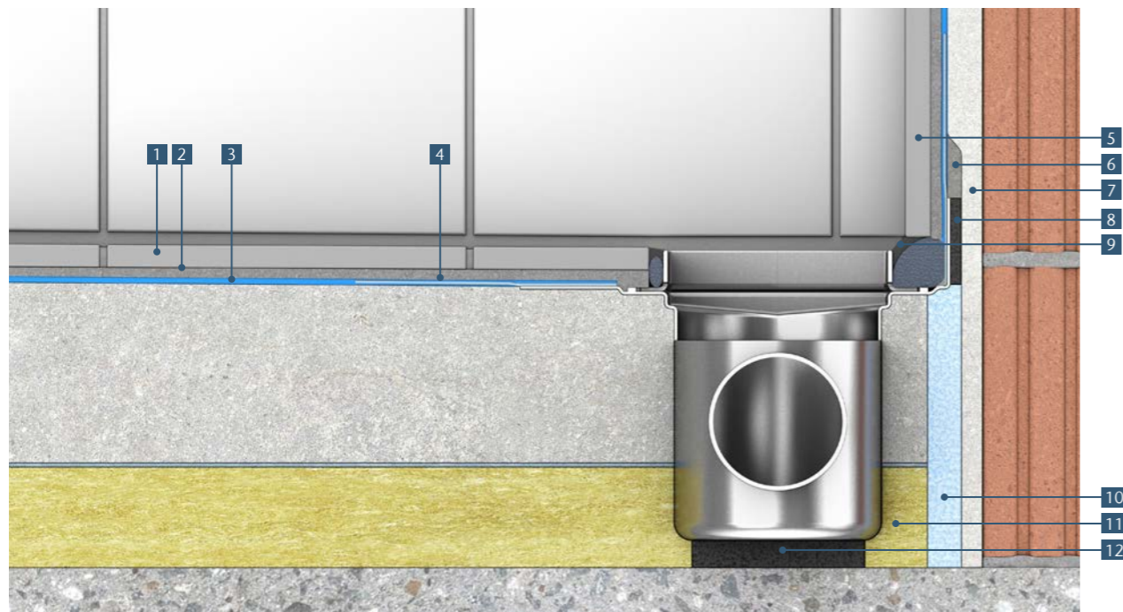
Предложение за монтаж на ACO ShowerDrain E+ (подова конструкция съгласно протокола за изпитване на шумоизолацията)
