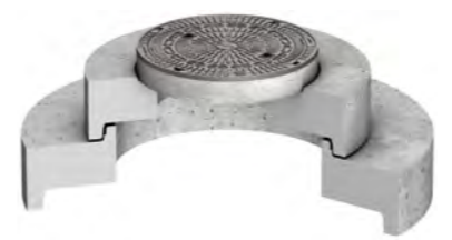
Надстройка от стоманобетон с преходна плоча и капак на шахта от чугун, клас на натоварване D400 съгласно EN 124
