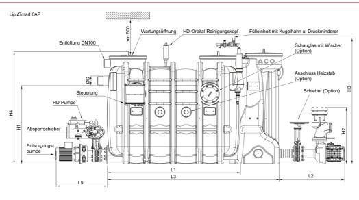
dargestellt: NS 4, Bedienungsseite rechts, bei Bedienungsseite links sind die Bauteile (Entsorgungsanschluss, Fülleinheit, Schauglas, Steuerung) zur Mittelachse des Abscheiders spiegelbildlich angeordnet.
