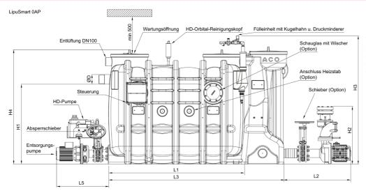
dargestellt: NS 4, Bedienungsseite rechts, bei Bedienungsseite links sind die Bauteile (Entsorgungsanschluss, Fülleinheit, Schauglas, Steuerung) zur Mittelachse des Abscheiders spiegelbildlich angeordnet.
