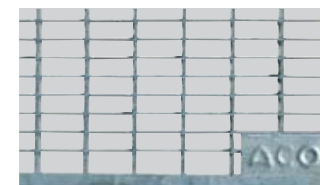
Мрежеста решетка с големина на отворите 30x10 mm, носимоспособност от 1,5 до 9 kN
