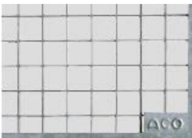
Мрежеста решетка, Размер на дупките 30 x 30, издържаща на натоварване за пешеходци до 350 kg/m 2
