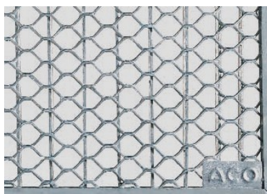
Опъната метална решетка издържаща на натоварване до 250 kg/m 2 , за пешеходци и за автомобили до 400 kg на колело
