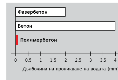
Дълбочина на проникване на водата (DIN 4281) на различни материали за отводнителни улеи след 72 часа
