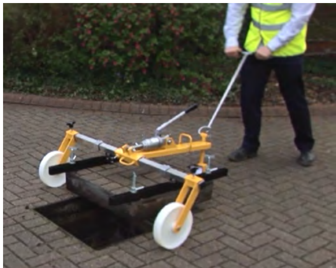
Хидравличен крик за допълнителна лекота при отваряне на капака. Особено подходящ за големи размери.
