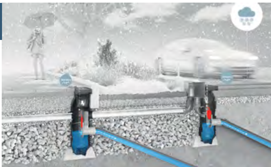
Фигура 4: Зимен режим: разделителните шибъри са отворени - заустване в канализацията
