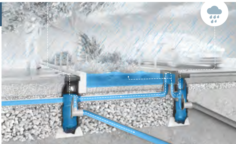
Фигура 3: Тялото на Sponge city е наситено - не е задължително да прелее в канализацията
