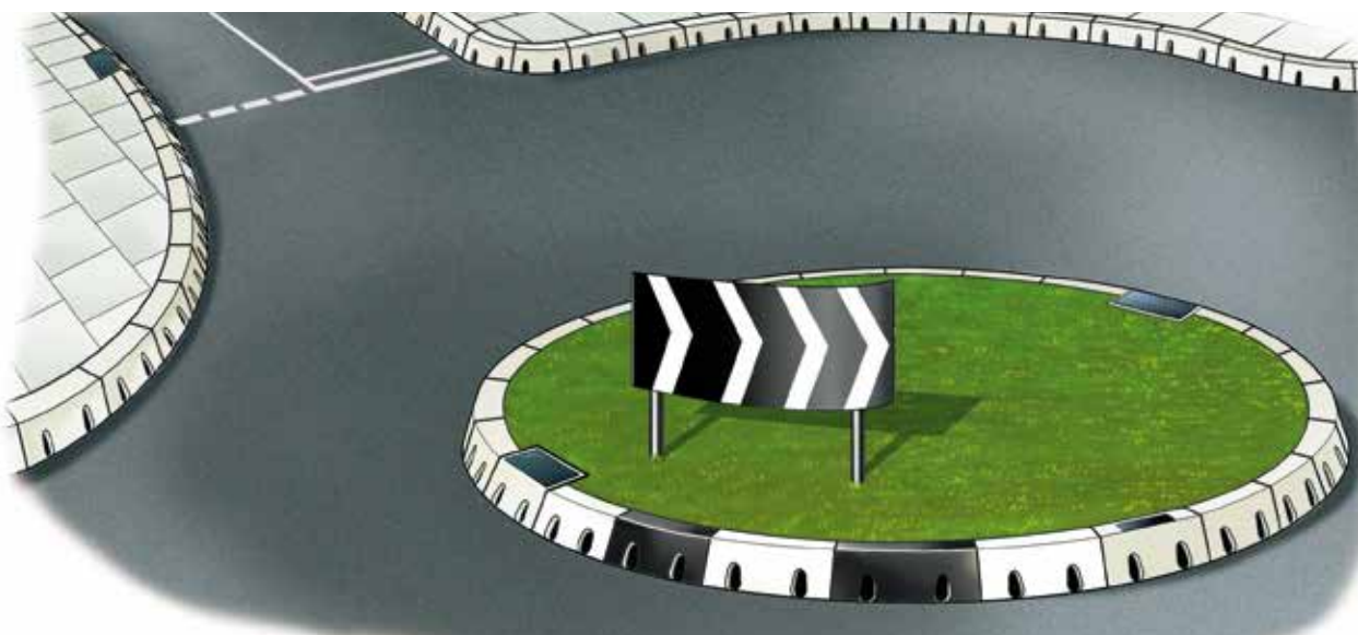
ACO KerbDrain външен и вътрешен радиус на кръгово движение
